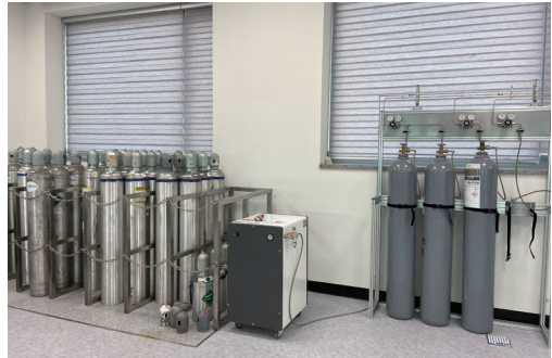
온실가스 중앙실험실 장비들 (WMO/CCL3차 표준가스 및 표준가스주입시스템)
