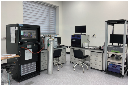
온실가스 중앙실험실 장비들 (SF 6 전처리장치, SF 6 분석기, N 2 O/CO 분석기, CO 2 /CH 4 분석기 기준)
